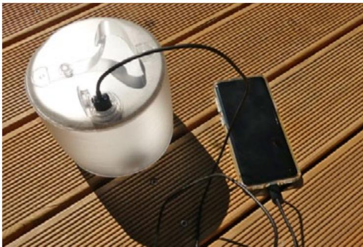
Eine ganz andere Idee hatte die New Yorker Firma MPOWERD. Sie entwickelte eine Zeltlampe zum Aufblasen. Was anfangs etwas verrückt klingt, ist eine LED-Lampe mit Solarzelle, an der auch ein Handy aufgeladen werden kann. Sicherlich dauert das wesentlich länger als zu Hause an der Steckdose, doch bei einigen Versuchen konnten wir unser Handy in 6 Stunden wieder zu 60% laden und abends hatten wir im Zelt ausreichend Licht. Von der Redaktion bekommt die Lampe eine klare Kaufempfehlung.
